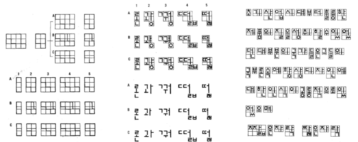
[그림2.8] 조영제의 타자기 한글서체 안. 왼쪽은 3종의 모듈, 가운데는 각 모듈 적용 서체의 예, 오른쪽은 조영제가 가장 이상적이라 판단한 모듈에 적용한 사례. 조영제 (1976), 한글 機械化(打字機)를 위한 構造의 研究, 조형 창간호, 서울대학교 출판부, pp.45-47.
